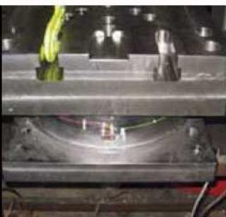
(oben) Maschinenfähigkeitsmessung an einer 4000 to Presse, (unten) DMS Ausrüstung zur Ausziehtopfkraftmessung
